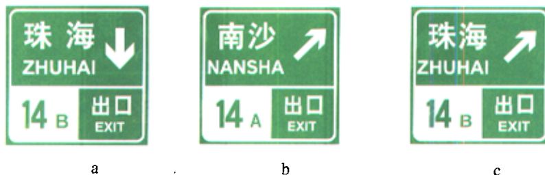
路36 出口预告 (两个出口)
