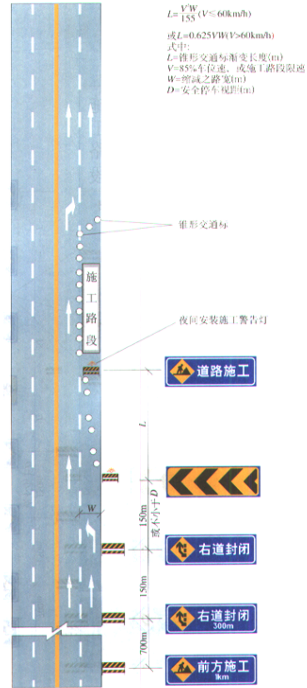
图J5 同向车道中有一条车道路面施工时设施布设例
