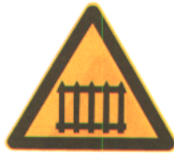
警33 有人看守铁路道口
